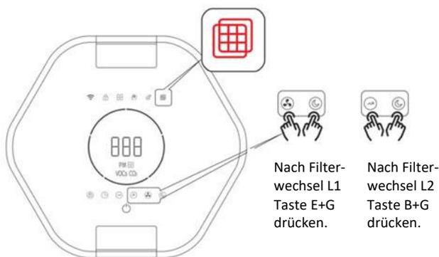
**HINWEIS:** Drücken Sie nach dem Filterwechsel die Tasten wie in der Abbildung beschrieben 5 Sekunden lang, bis ein Tonsignal ertönt. Anschließend wird die Anzeige auf den Ausgangszustand zurückgesetzt.
